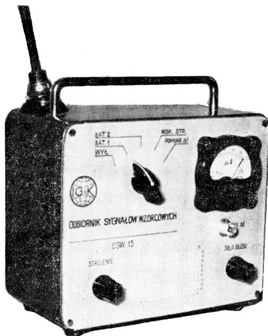
Rys. 4. Tranzystorowe urządzenie do polowej kontroli częstotliwości wzorcowych
