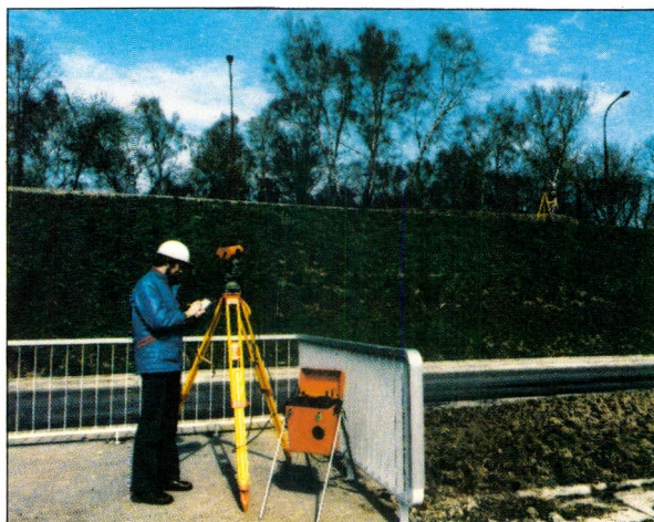
Fot. 25.4. Pomiar odległości dalmierzem Wild DI-10
