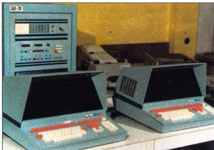
Fot. 27.4. System minikomputerowy Geo 20 w CIGiK. Jednostka centralna i dwa stanowiska wprowadzania danych
