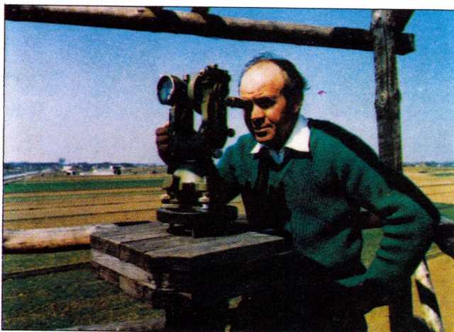
Fot. 25.1. Obserwacje na wieży triangulacyjnej teodolitem Wild T-3 wykonuje geodeta A. Zbrzeźniak z PPGK
