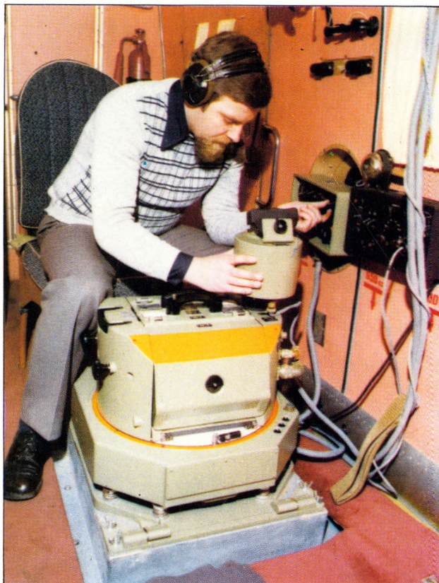
Fot. 26.3. Kamera Wild RC-10 zainstalowana w samolocie przystosowanym do wykonywania fotogrametrycznych zdjęć lotniczych. Przy kamerze technik fotooperator Jerzy Winiarski, z-ca kier. grupy fotolotnicznej PPGK
