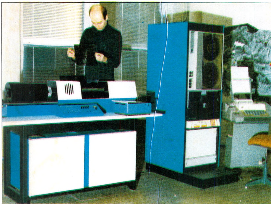
Fot. 28.3. Pracownia OPOLIS w IGiK. Aparatura Optronics do zamiany zapisu taśmy magnetycznej na obraz fotograficzny i odwrotnie
