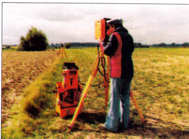
Fot. 25.2. Pomiar sieci poligonowej tachime- trem AGA-700 automatycznie rejestrującym
