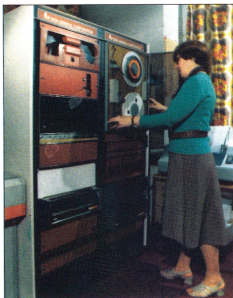
Fot. 27.5. Minikomputer Nova 840 zainstalowany w CIGiK Inż. Irena Łaś – Ronisz w trakcie zmiany taśmy magnetycznej
