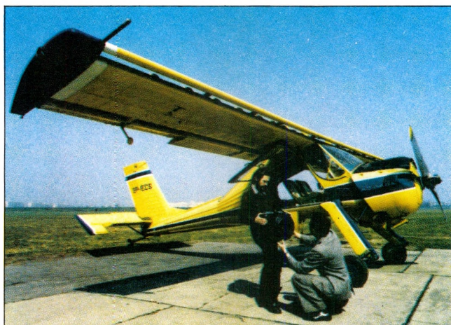
Fot. 26.1. Samolot „Wilga” przystosowany do fotointerpretacyjnych prac doświadczalnych. Przygotowania do wykonywania zdjęć fotogrametrycznych
