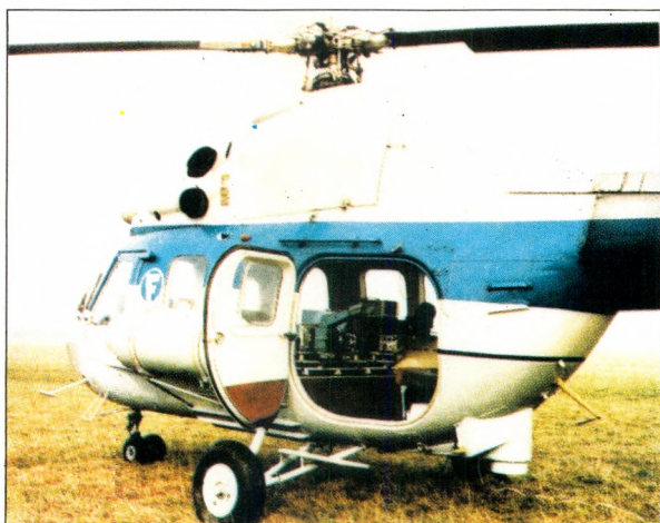
Fot. 26.2. Śmigłowiec Mi-2 przystosowany do wykonywania zdjęć fotogrametrycznych
