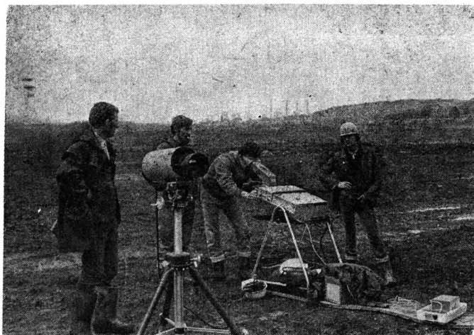
Kartowanie za pomocą kamery termalnej układu warstw węglowych w kopalni odkrywkowej
