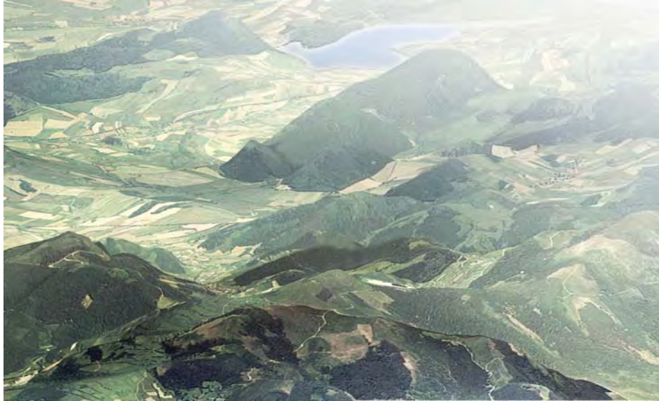
Rys. 15. Perspektywa numerycznego modelu terenu ze zdjęciami lotniczymi (zastosowano perspektywę powietrzną i barwną)
