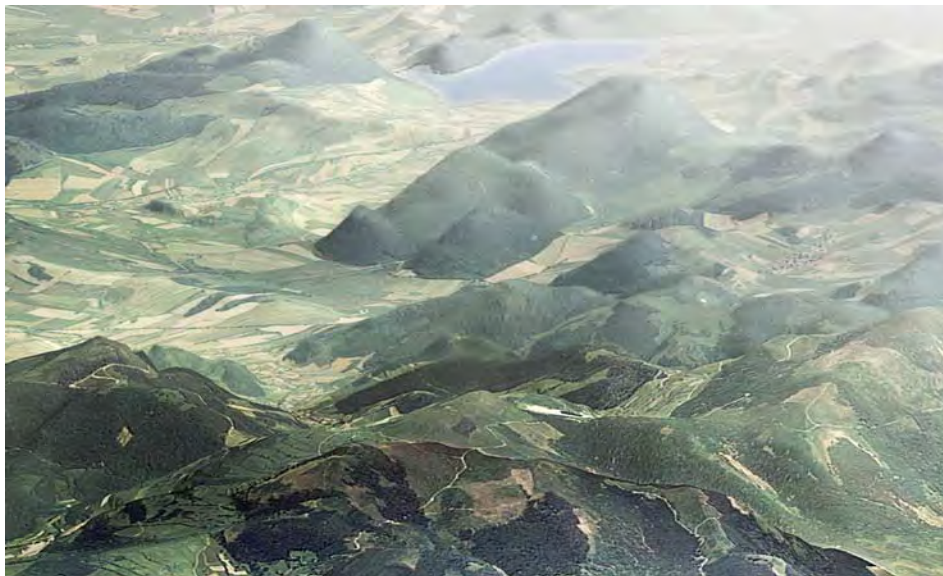
Rys. 16. Perspektywa numerycznego modelu terenu ze zdjęciami lotniczymi (zastosowano perspektywę powietrzną i barwną oraz wprowadzono cieniowany obraz rzeźby terenu)
