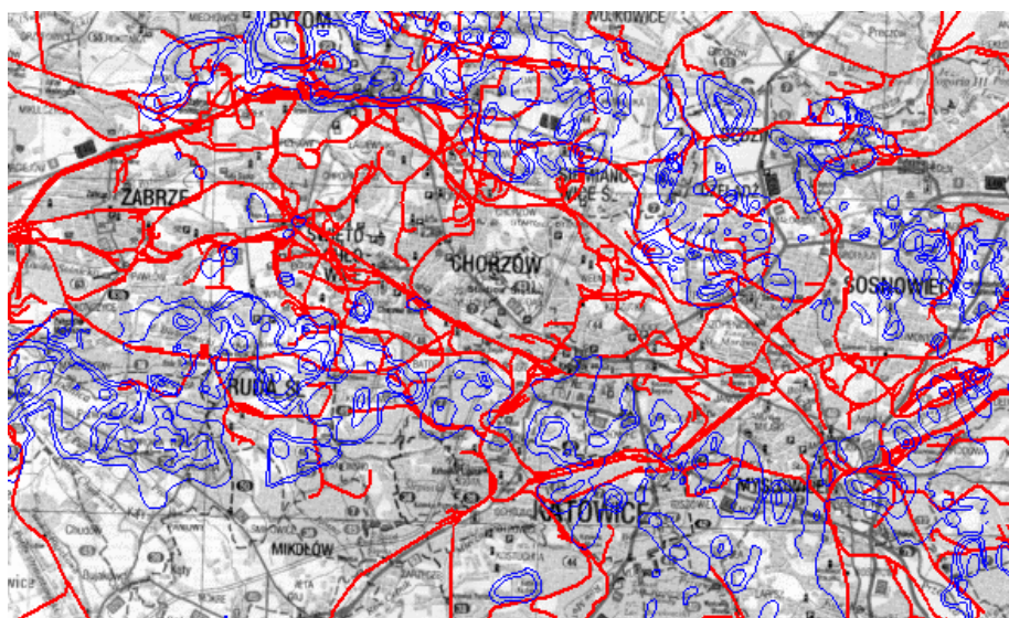
Rys. 3. Analiza możliwości wykorzystania naturalnych korytarzy komunikacyjnych w aglomeracji przemysłowej, z uwzględnieniem szkód górniczych (osiadania terenu w określonym przedziale czasu). Korytarze komunikacyjne były indywidualnie kompilowane i kolorowane, a tło kopiowane (Z. Heliasz i S. Ostaficzuk, Katedra Geologii Podstawowej U.Śl.)
