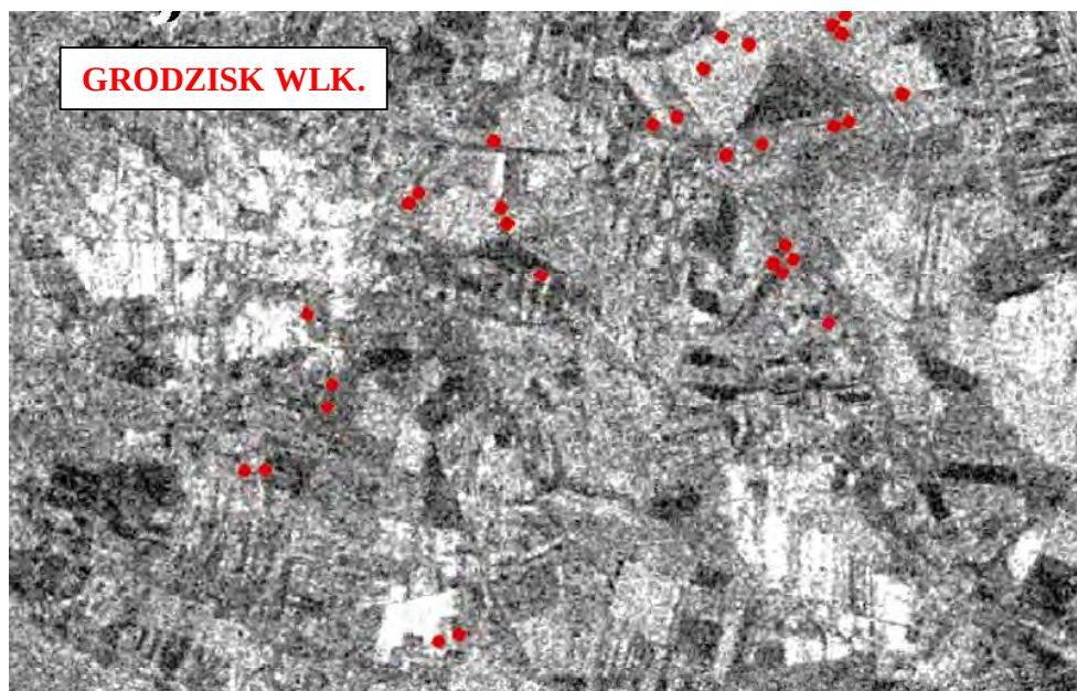
Rys 2. Zdjęcie mikrofalowe ERS-2.SAR.PRI z zaznaczonymi punktami pomiarowymi na polu testowym Grodzisk Wielkopolski
