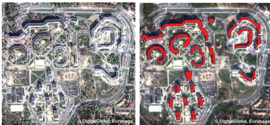
Rys. 12. Przykład segmentacji i klasyfikacji wysokiej zabudowy wykonanej na podstawie wysokorozdzielczego zdjęcia satelitarnego QuickBird (Lewiński i Zaremski, 2004)
