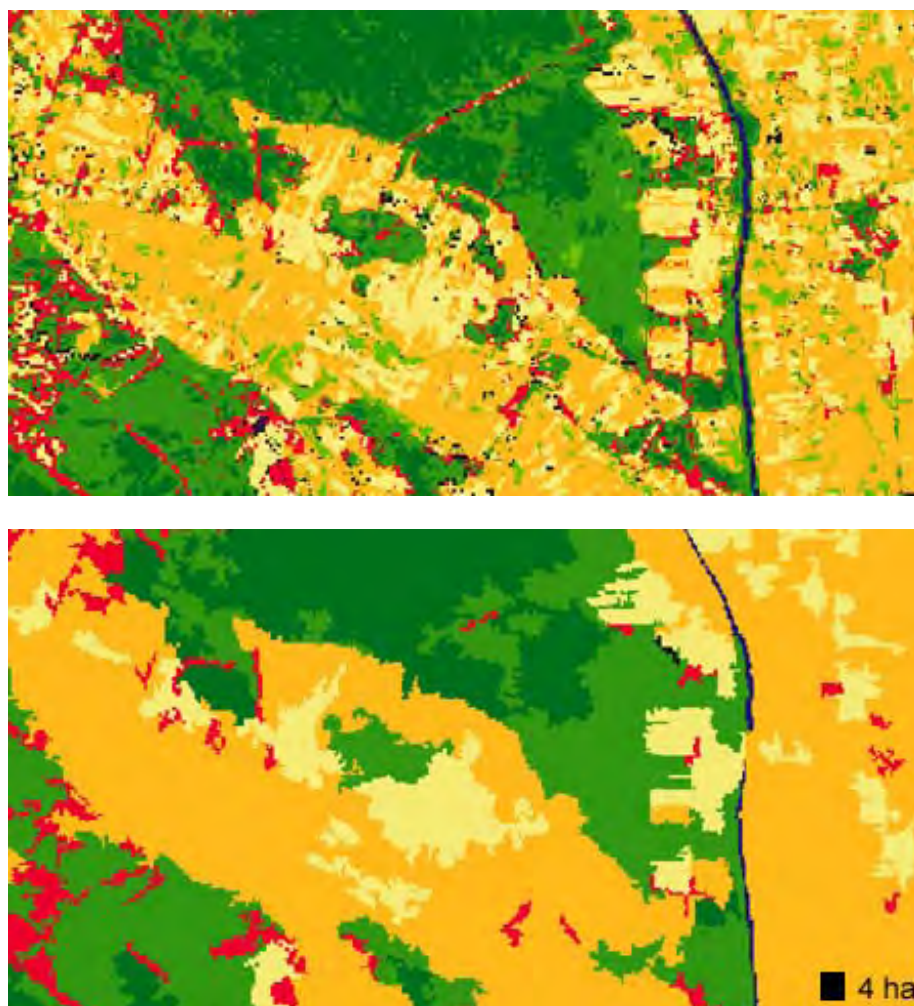
Rys. 10. Fragment obrazu klasyfikacji hybrydowej przed (górny) i po generalizacji (dolny)
