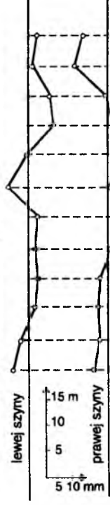
Rys. 7. Wykresy położenia szyn pod obciążeniem (nakładka B)
