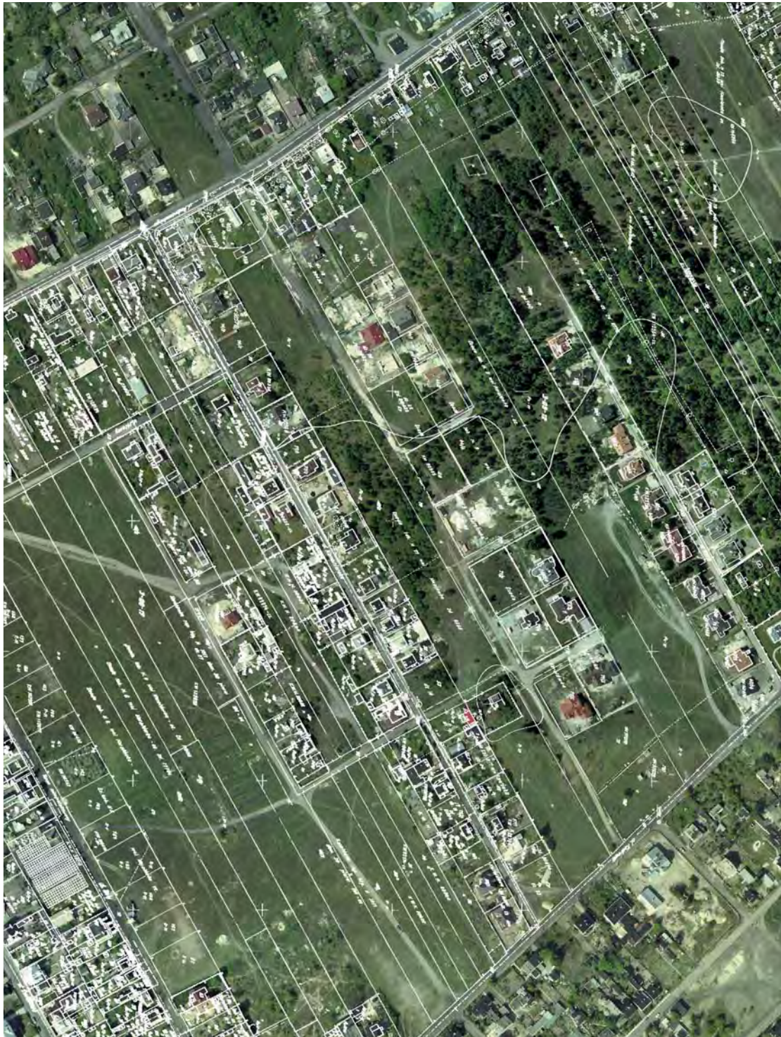
Rys. 5. Rastrowy obraz mapy ewidencyjnej gruntów i budynków nałożony na barwną ortofotomapę cyfrową
