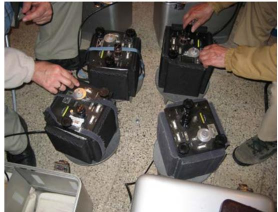
Rys. 6. LaCoste&Romberg gravimeters
