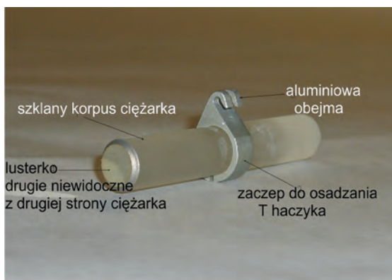
Rys. 3.6. Szklany ciężarek do rozkręcania nici w deklinatorze niciowym
