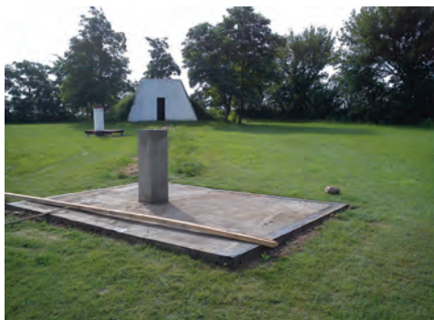
Rys. 1.24. Punkt bazowy zastabilizowany słupem betonowym
