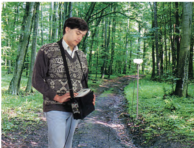
Rys. 4.6. Pomiary terenowe magnetometrem protonowym
