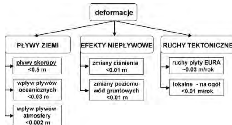
Rys. 3. Źródła i rodzaje deformacji skorupy ziemskiej i ich wpływ na pozycje stacji
