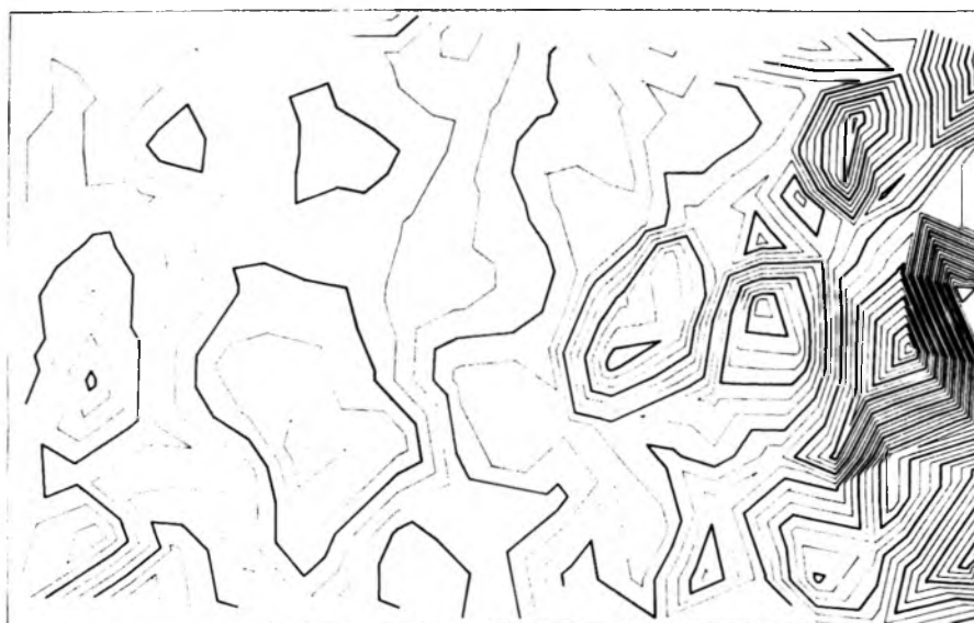
Rys. 2. Izogony co 10'. Interpolacja izogon automatyczna. Dane wyjściowe — zbiór wartości D na rozproszonych punktach zdjęcia magnetycznego
