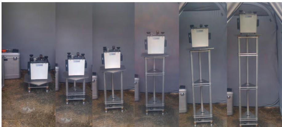
Rys. 15. Statyw do precyzyjnego wyznaczenia gradientu pionowego przyspieszenia siły ciężkości
