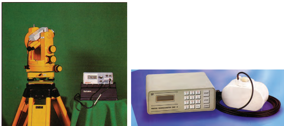
Rys. 9. Teodolit Zeiss z sondą magnetometru Flux-Gate D/I oraz magnetometr protonowy z sondą
