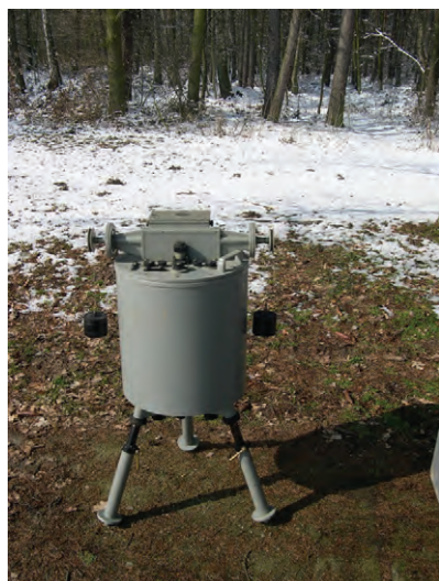
Rys. 8. Wariograf magnetyczny Askania z archiwalnym graficznym zapisem
