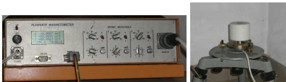
Rys. 10. Magnetometr LEMI do rejestracji zmian składowych pola geomagnetycznego X , Y i Z wraz z zestawem sond
