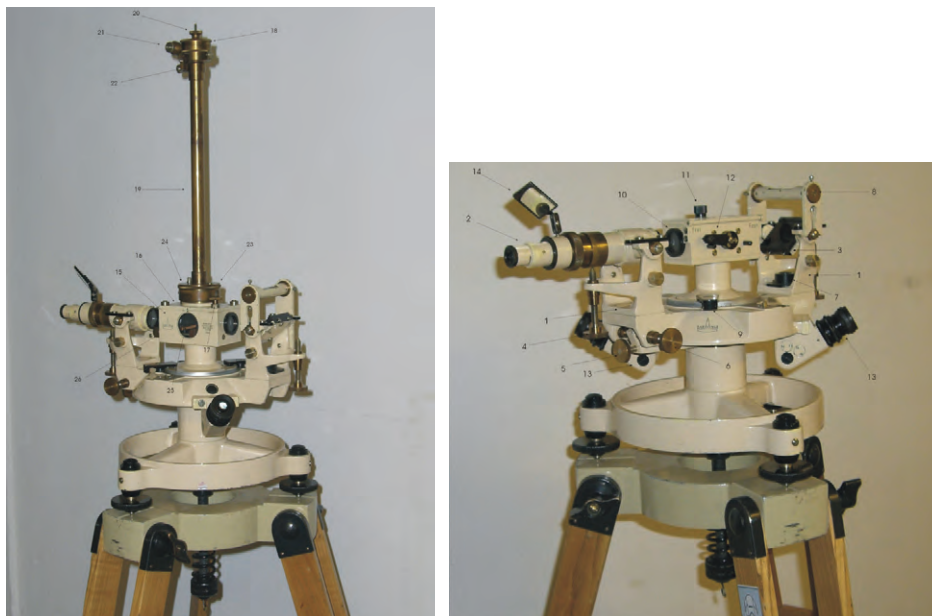
Rys. 7. Teodolit Askania z deklinatorem igłowym (lewy rysunek) i niciowym
