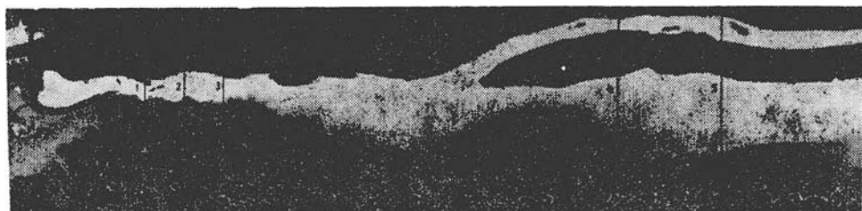
Rys. 12. Obraz termalny fragmentu badanego odcinka Wisły poniżej zrzutu ciepłej wody z Elektrowni „Kozienice”, wykonany za pomocą AGA Thermoprofile Model THP-1 (19. 08. 1974 r., godz. 19.17)
