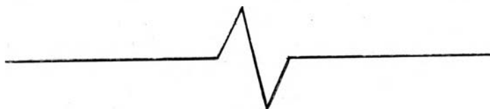
Rys. 21. Szkic fragmentu wykresu chodów przy jednym błędnym odbiorze sygnału czasu
