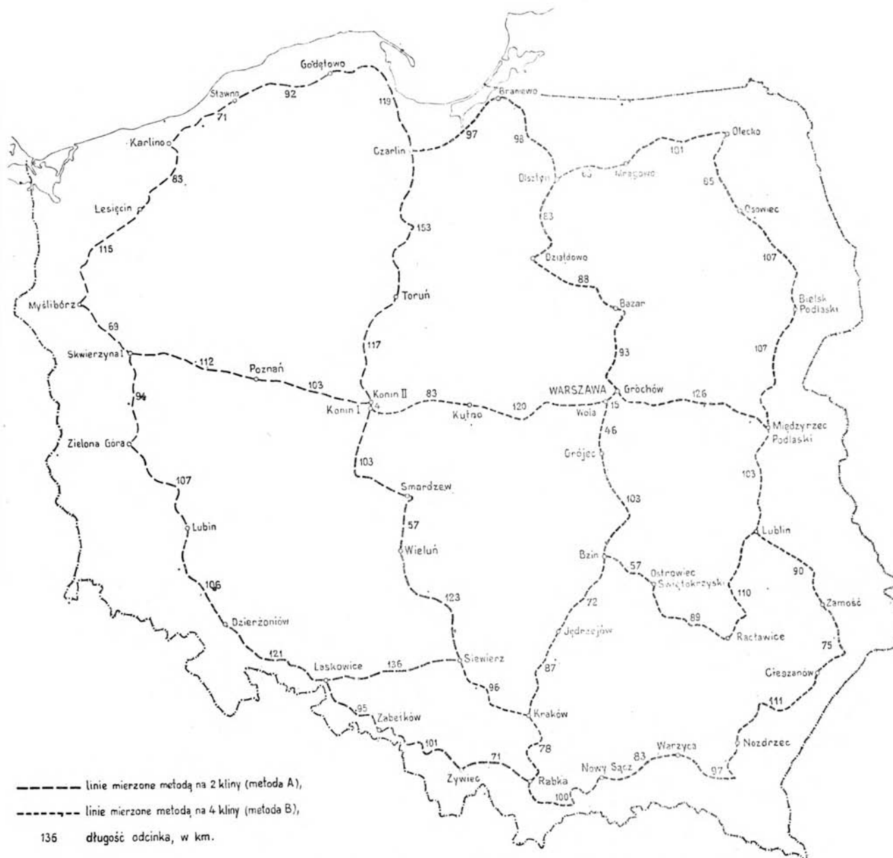
Rys. 4. Szkic linii sieci niwelacji precyzyjnej I klasy, wykorzystanych jako materiał do analizy dokładności wzorami Vignala. Podział na krótsze linie, dla których wyznaczane były linie wyrównujące
