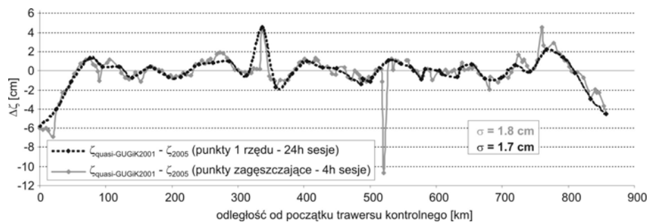
Rys. 20. Zgodność anomalii wysokości kompleksowego modelu quasigeoidy „2005” z modelem quasigeoidy GUGiK 2001 na punktach trawersu kontrolnego
