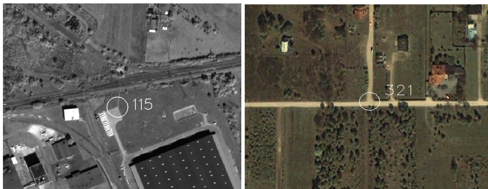
Rys. 1. Projekt punktów osnowy fotogrametrycznej na obrazie QuickBird (po lewej) oraz Ikonos (po prawej)
